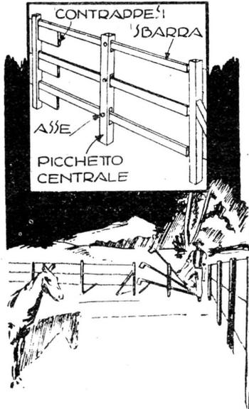
Questo cancello si compone di tre sbarre trasversali che attraversano il picchetto centrale dell'apertura, limitata da altri due picchetti cui sono fissati i fili spinati che compongono lo sbarramento.
