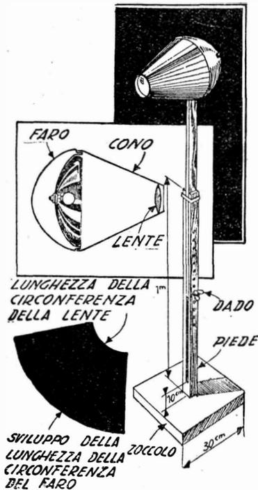
Ecco un proiettore per gli amatori di fotografia, capace di emettere un fascio luminoso più che sufficiente a permettere l'esecuzione di ottimi ritratti alla luce artificiale.
