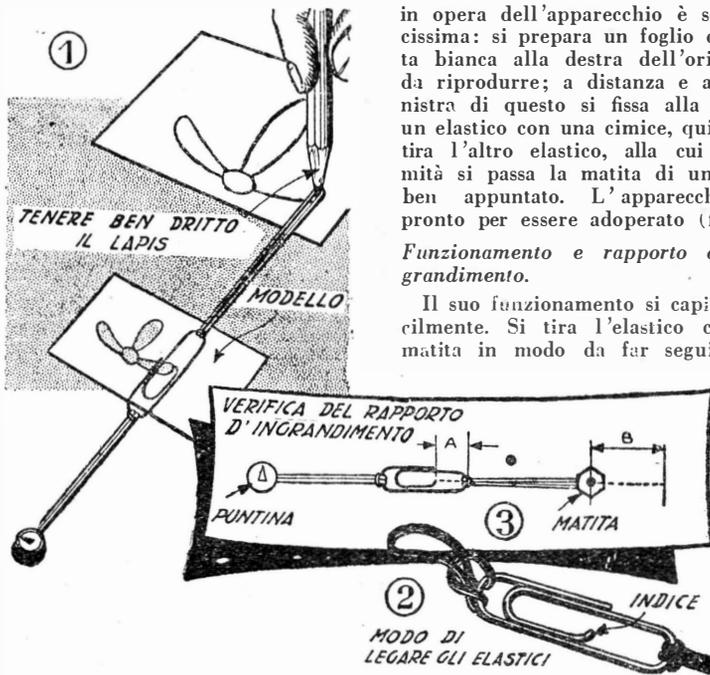
Come tutti sanno, il pantografo serve a riprodurre qualsiasi disegno ingrandendolo. Il rapporto dell'ingrandimento varia a seconda della lunghezza dei bracci che costituiscono il pantografo. Questo apparecchio, sia pure facile a costruirsi, necessita di un lavoro assai delicato, che risulta superfluo quando si desidera effettuare occasionalmente una riproduzione per la quale non sia richiesta una grande precisione.
