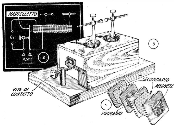
È noto quante esperienze elettriche assai divertenti, e non divertenti soltanto, possano farsi con un rocchetto di Ruhmkorff. Ma un apparecchio del genere costa assai caro, a doverlo acquistare nei negozi, ed ecco che abbiamo pensato ad insegnare ai nostri lettori come fabbricarsene uno con vecchi pezzi di radio fuori uso, e particolarmente con due trasformatori di rapporto 1-3.
