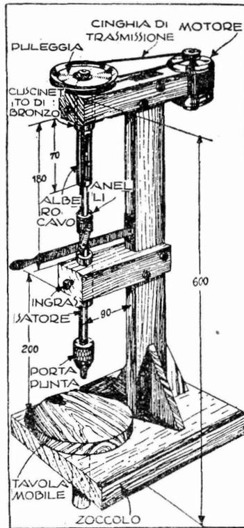
rata una tavola regolabile in altezza, o munita di una leva di comando, tavola il cui sostegno passerà attraverso il blocco di legno che forma lo zoccolo dell'utensile.
