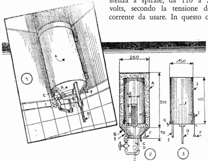
un foro laterale per il passaggio del tubo di rame contenente il termostato I (figura 3 e dettaglio fig. 4), ed esser munito di tre grappe G, che verranno saldate alla sua estremità inferiore. Tali grappe faranno presa sul bordo interno dello scaldabagno, e saranno tenute in sito da gocce di saldatura (vedi figura 2).
