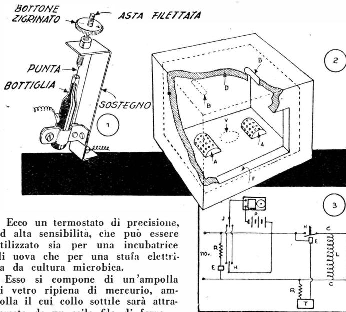
Ecco un termostato di precisione, ad alta sensibilità, che può essere utilizzato sia per una incubatrice di uova che per una stufa elettrica da cultura microbica.
