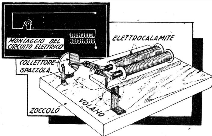
Questo motorino elettrico funziona con corrente continua ed alternata da 10 a 12 volts. Le sue parti fondamentali sono date da due bobine di elettrocalamite, ottenute avvolgendo circa 700 spire di filo isolato di 4/10 su carcasse metalliche.
