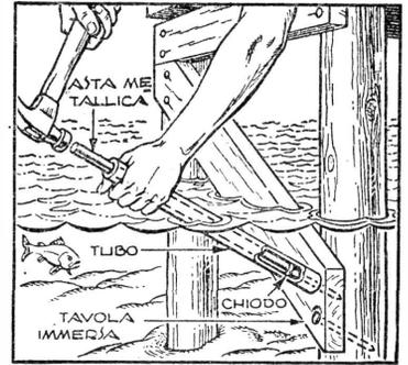
Un tubo metallico di conveniente lunghezza ed un'asta metallica che possa scorrervi dentro, serviranno benissimo a piantare chiodi in tavole che si trovano sotto il livello dell'acqua.
