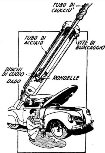
Per vuotare recipienti che contengono liquidi nauseabondi o perniciosi (benzina, nafta, alcool denaturato, ecc.), consigliamo la preparazione di questo sifone ad adescamento semi automatico da usare per il pompaggio. Tutti i pezzi che lo compongono sono di recupero, e pertanto il costo dell'utile strumento si riduce in pratica a zero.
