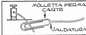
Nel corso del montaggio o della prova di un circuito elettrico avviene spesso di aver bisogno di un collegamento elettrico di facile maneggio. Quello che vi presentiamo è praticissimo, può tenere a posto numerosi fili, e per esser fatto non richiede che una di quelle mollette che si usano come ferma carte.
